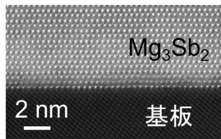
図 2 \text{Mg}_3\text{Sb}_2 薄膜の HAADF-STEM 像.
